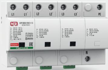
Для защиты электрооборудования от импульсных перенапряжений, вызванных ударами молнии в систему молниезащиты объекта или линию электропередач, межоблачными разрядами, коммутацией нагрузок, остаточных бросков напряжения. Не требуют установки УЗИП дополнительных ступеней защиты при расстоянии до защищаемого оборудования не более 5 м по кабелю.
