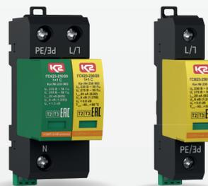
Для защиты электрооборудования от импульсных перенапряжений, вызванных межоблачными разрядами, коммутацией нагрузок, остаточных бросков напряжения. Не требуют установки УЗИП дополнительных ступеней защиты при расстоянии до защищаемого оборудования не более 5 м по кабелю.
